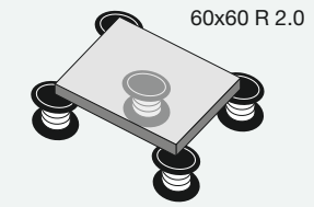
Instalación elevada Raised floorings Pose plancher sur-élevé
